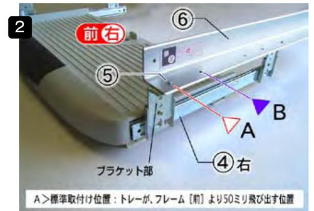
レール金具④右のブラケット部(2ヶ所)を、ALアングル⑥のA位置(またはB位置)に取付ネジ⑤でしっかり固定します。同じくALアングル⑦も対称に取付けます。
