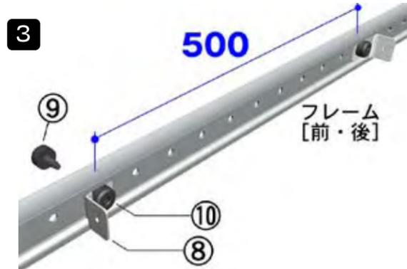
●キーボードトレイの取付け位置は、デスクの脚フレームの間口方向に対して、左右50ミリピッチで自由な位置にセットできます。
