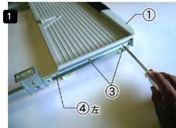
トレイ本体①の両サイドに、レール金具④左・右を取付皿ネジ③で2ヶ所づつ固定します。【注】取付皿ネジ③は、電動ドライバーなどで締め過ぎないようにご注意ください。
